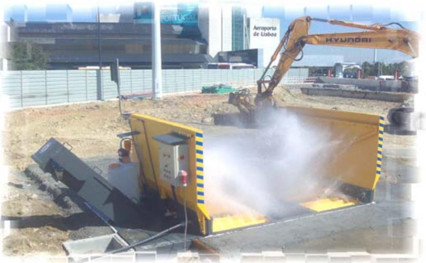
Die BT 2400 TCR Waschanlage ist ein vollautomatisches System, entwickelt zum waschen und reinigen von Reifen auf Baustellen. Die Anlage eignet sich zur Reinigung aller Lastkraftwagen sowie auch allen anderen Nutzfahrzeugen mit Rädern oder Gummiraupen. Der Betrieb der Anlage basiert auf zwei Fotozellen, welche die Ankunft der Fahrzeuge registrieren und per integrierter Ampel die Freigabe signalisieren.
